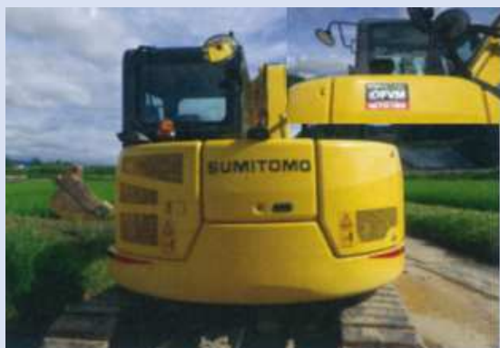
後方監視カメラ搭載BH建設機械
